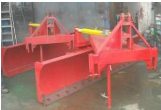
Имеет ширину 3 метра, может быть подготовлен с пружинами или без них (версия с пружинами также используется для снега).
