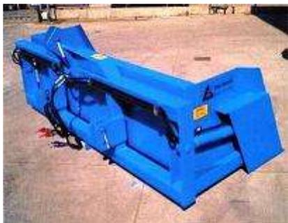
Отвал оснащен гидравлической системой с двумя поршнями для разгрузки, конструкция которой усилена за счет наклона на 90 °.
