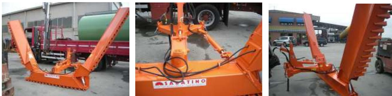
Оснащена четырьмя гидравлическими поршнями: две стороны для открывания и закрывания крыльев для транспортировки на улице, одна, которая позволяет регулировать угол падения лезвия на землю, и, наконец, последний боковой поршень для управления углом вращения выравнивателя относительно направления движения.
